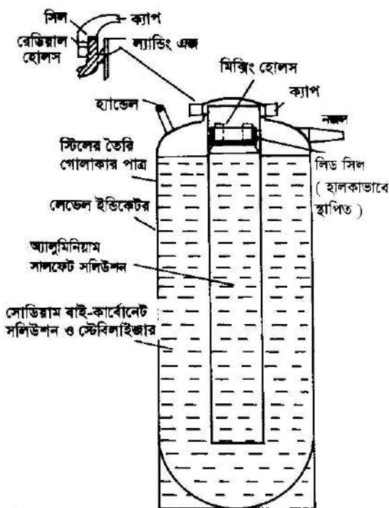
চিত্র ১৫.৫ : ৯ লিটার পোর্টেবল অগ্নিনির্বাপক যন্ত্র।
